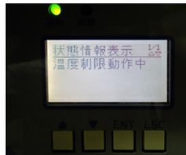
室内温度が高いため、PCS の保護機能が働き出力を抑制していたわけです。遠隔監視装置を設置したことにより夏季の3か月間、売電ロスしていたが遠温度抑制に気づき売電ロスが解消されました。
