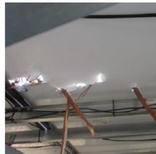
倒木によるモジュールの破損
