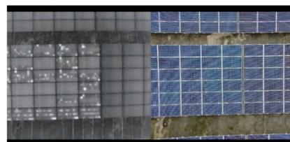
これはドローンで可視画像と赤外線画像を同時に撮影したものです。右の可視画像では問題無いように見えますが、左のIR画像を見ると、無数のホットスポット(異常発熱箇所)が検出されています。これは、典型的な落雷による被害の例です。一般的に落雷被害があった場合、発電量の低下など手がかかる場合が多いのですが、近年「過積載」と呼ばれる、PCSの出力を大幅に上回る容量の太陽光パネルを設置することが主流となっていることから、落雷被害で発電出力が多少下がったとしても、過積載によって出力が落ちていることに気が付かないというこ
