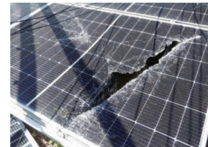
駆けつけたスタッフで発電所全体の被害状況を調査し報告させていただくとともに、今後の復旧に関する提案をさせていただきました。また、太陽光パネルは単体でも太陽光が当たれば発電するため、感電や火災の恐れもありますので、飛散していたパネルは日陰に移動し、まとめておきました。
