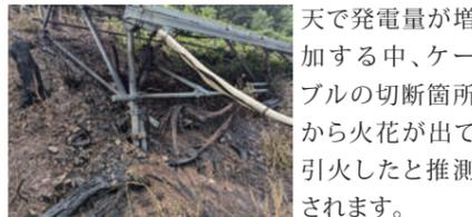
天で発電量が増加する中、ケーブルの切断箇所から火花が出て引火したと推測されます。
