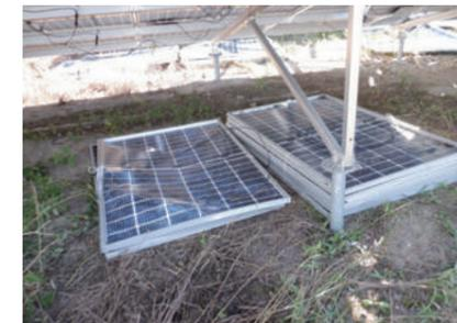
目視では破損が確認できないパネルでも、衝撃でセルクラックやセルショートなどの不具合が発生しているかもしれません。不具合が進行していき、徐々に発電量が落ちていったという事例も
